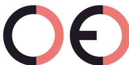
Marca CE falsa (demasiado separados)
